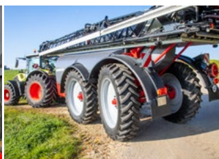
На выбор предлагается одна пассивная поворотная ось либо активное рулевое управление для обеих
